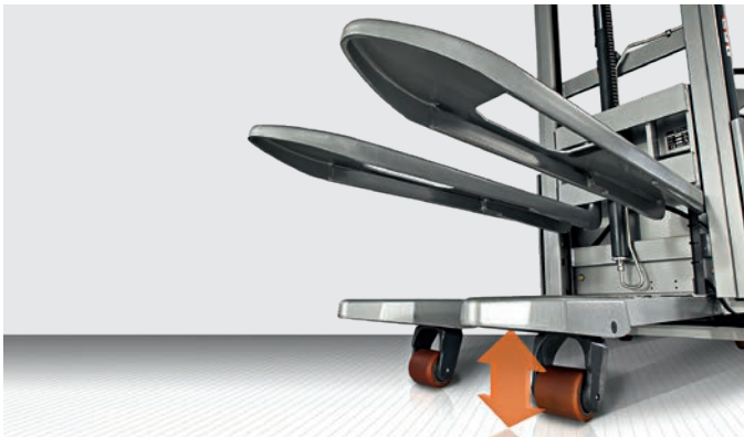
Mehr Bodenfreiheit für unebene Böden dank des optionalen Initialhubs
