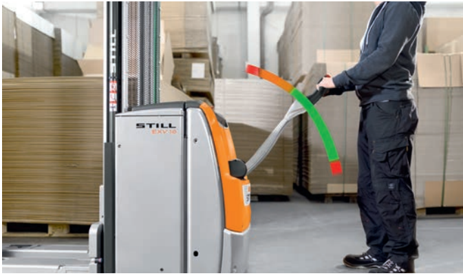
Sicherheit in Serie: Geschwindigkeit passt sich deichselwinkelabhängig automatisch an den Abstand des Fahrers zum Fahrzeug an
