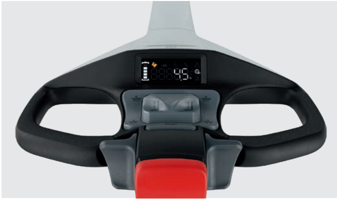
Ein kurzer Blick auf das LED-Display genügt, um alle relevanten Fahrzeuginformationen übersichtlich vor Augen zu haben
