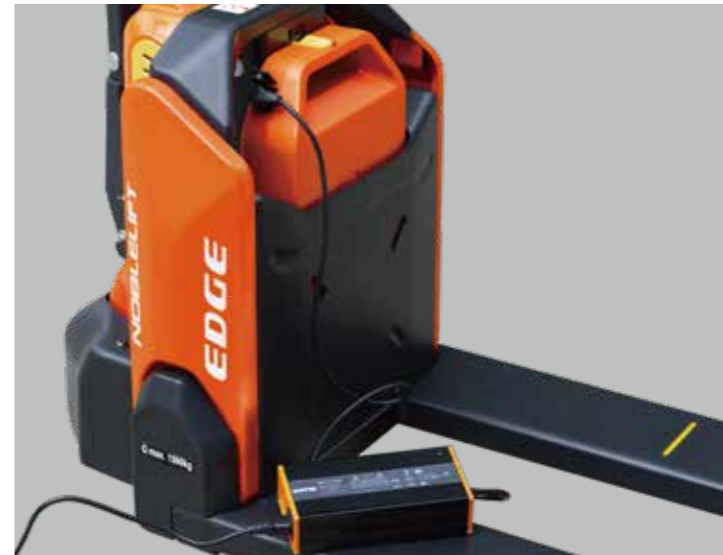
Ladestecker an der Batterie für einfaches Laden ohne die Batterie zu entnehmen.
